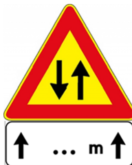
Figura 7.2.i: segnale Fig. II 387 Art. 31 del Reg. con cartello integrativo modello II 2 art. 83 di estensione da installarsi sulla corsia non deviata.
