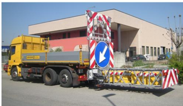
Figura 8.3.c: esempio di assorbitore d'urto abbinato al segnale mobile di protezione Fig. II 401 Art. 39 del Reg.
