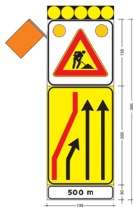
Figura 8.2.b: «presegnale di cantiere mobile» Fig. II 399/a Art. 39 del Reg. È integrato con set di 5 lampade a led ad alta efficienza luminosa diam. 200 mm (con possibilità di lampeggio sincrono e sequenziale) e con sbandiatore elettromeccanico posto in alto sul lato esposto al traffico.
