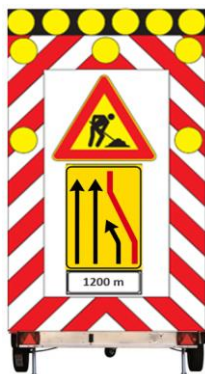
Figura 7.2.c: fig. II 400 art. 39 del Reg. per la chiusura di una o più corsie di transito (la figura esemplifica la chiusura della corsia di marcia). È integrato con set di 6 lampade a led ad alta efficienza luminosa diam. 300 mm (con possibilità di lampeggio sincrono sequenziale).
