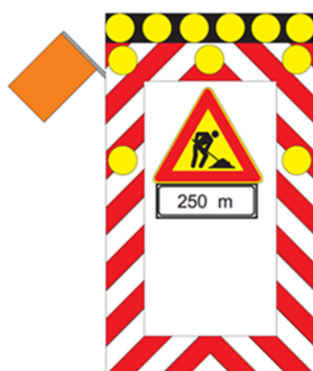
Figura 8.2.c: «segnale mobile di preavviso» derivato dalla Fig. II 400 Art. 39 del Reg. da impiegare per lavori sulla sola corsia di emergenza. È integrato con set di 6 lampade a led ad alta efficienza luminosa diam. 300 mm (con possibilità di lampeggio sincrono e sequenziale) e con sbandieratore elettromeccanico posto in alto sul lato esposto al traffico.
