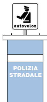
Figura 7.6.b: box autovelox mobile per cantiere di lavoro (tipo standard approvato dalla Polizia Stradale).
