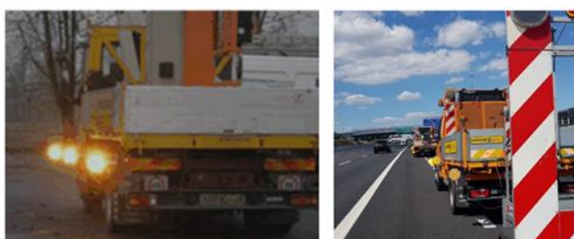
Figura 4.c: dotazione standard di lampade sul lato dell'autocarro esposto al traffico da utilizzare, ove richiesto dagli schemi, nei cantieri in lento movimento o in avanzamento. Il set è composto da 3 lampade a led diametro 200 mm a luce fissa omologate L8H.
