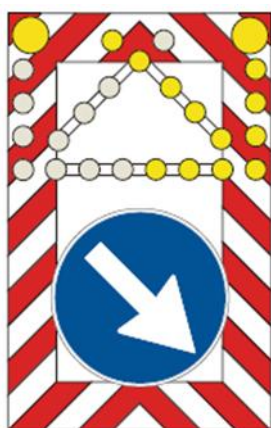
Figura 8.3.a: «Segnale mobile di protezione» Figura II 401 art. 39 del Reg.
