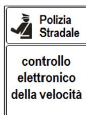
Figura 7.6.c: cartello di preavviso 90x135 cm da posizionare su cavalletto in anticipo rispetto alla posizione del box autovelox mobile.
