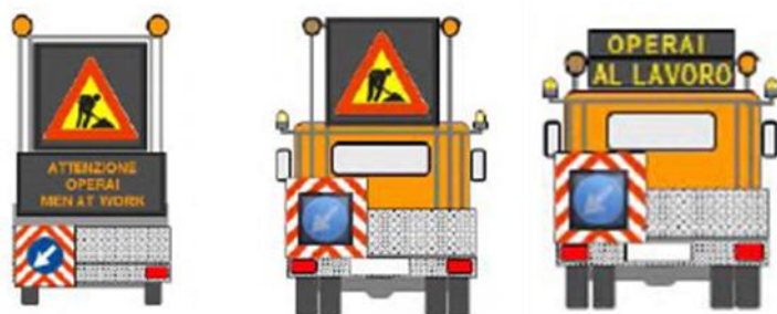
Figura 4.d: esempi di pannelli a messaggio variabile da utilizzare durante le fasi di posa e rimozione della segnaletica temporanea di cantiere. Il pannello "Lavori" deve avere dimensioni non inferiori a 120x96 cm. Il cartello Fig. II 398 Art. 38 Reg. (90x90) va sempre previsto.
