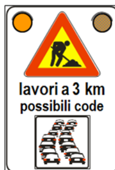
Figura 7.2.d: cartello di preavviso con lampeggiatori a led diam. 200 mm alta efficienza. Dimensioni 135x200 cm. Posizionamento sul margine destro su cavalletto a circa 3.000 m dal segnale "lavori"
