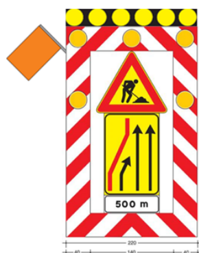
Figura 8.2.a: «segnale mobile di preavviso» Fig. II 400 Art. 39 del Reg. È integrato con set di 6 lampade a led ad alta efficienza luminosa diam. 300 mm (con possibilità di lampeggio sincrono e sequenziale) e con sbandiatore elettromeccanico posto in alto sul lato esposto al traffico.
