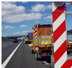
Figura 8.2.e: dotazione standard di lampade sul lato dell'autocarro esposto al traffico da utilizzare, ove richiesto dagli schemi, nei cantieri in lento movimento o in avanzamento. Il set è composto da 3 lampade a led diametro 200 mm a luce fissa omologate L8H.
