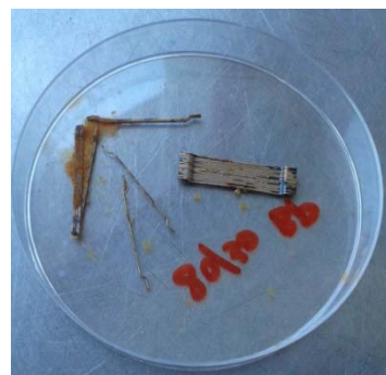
Fibre corrodibili, prova non superata
